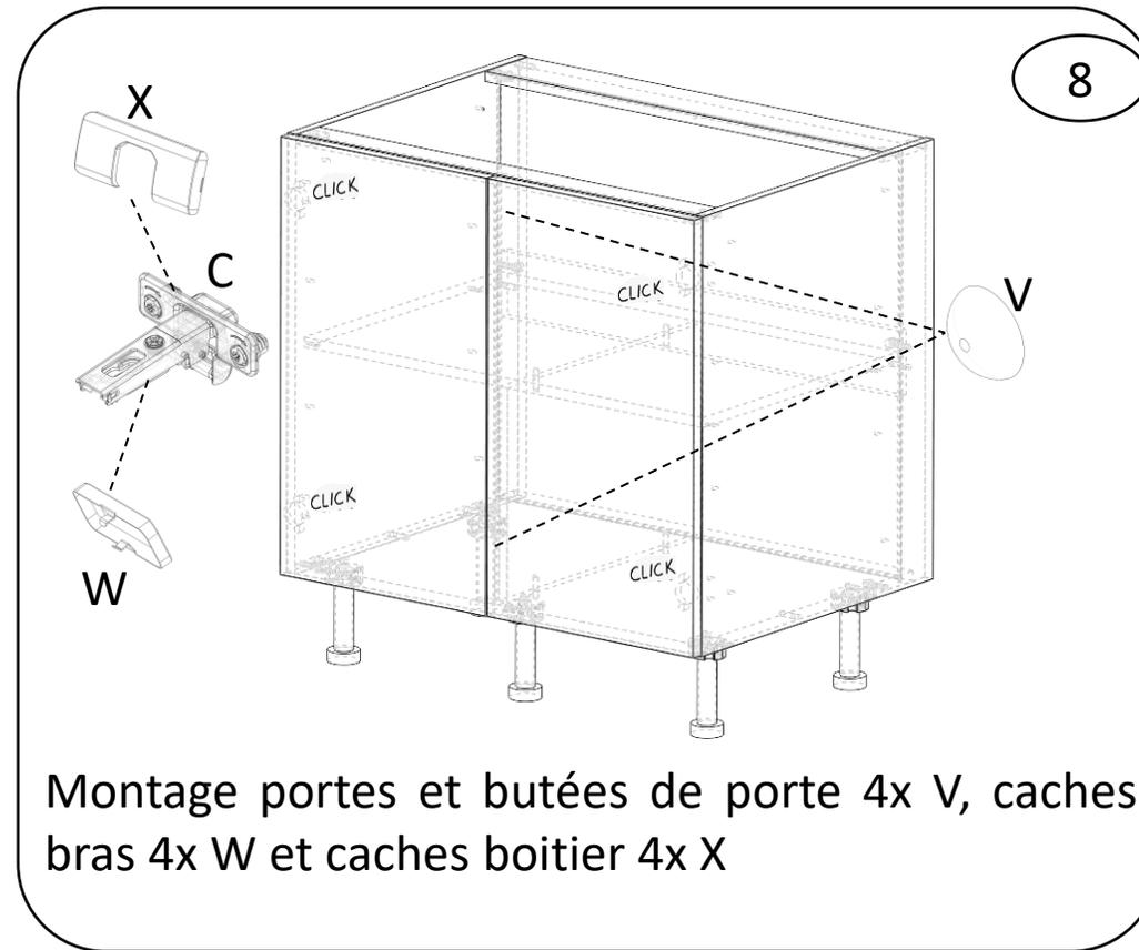
Montage portes et butées de porte 4x V, caches bras 4x W et caches boitier 4x X
