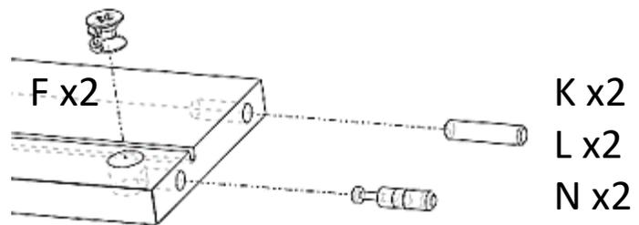
4 Monter les traverses F sur le coté C excentriques
