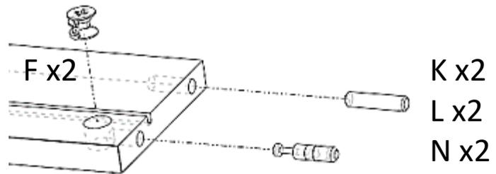
4 Monter les traverses F sur le coté C excentriques
